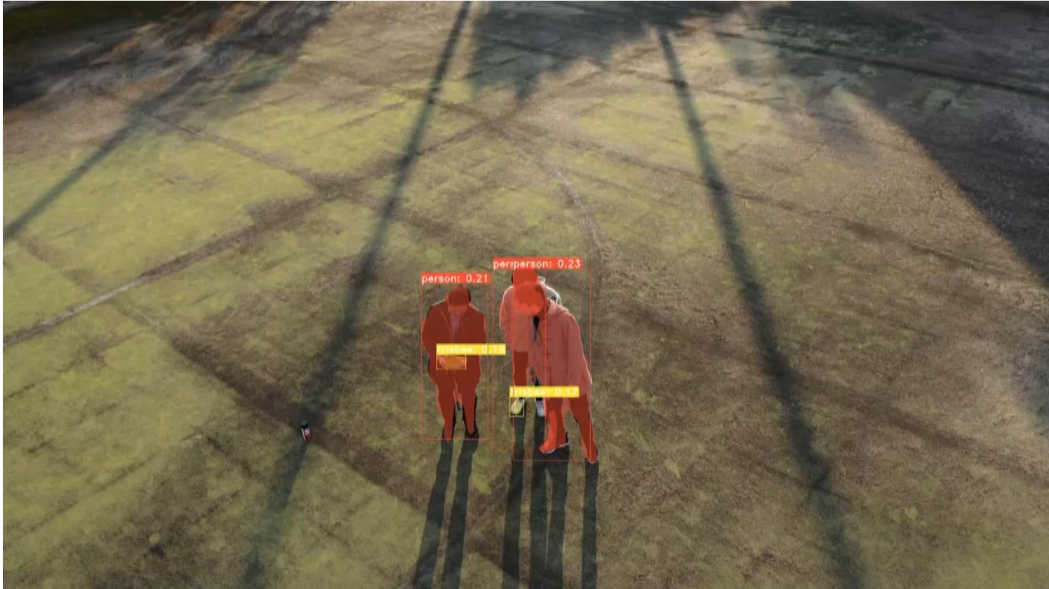
ドローン撮影画像に対する物体認識の適用（機体制御は未実施）
